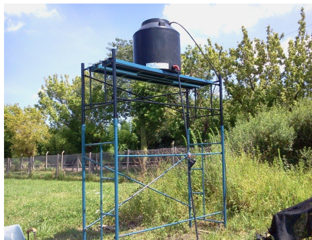
Foto N° 2: Andamio y tanque de agua como reservorio.
